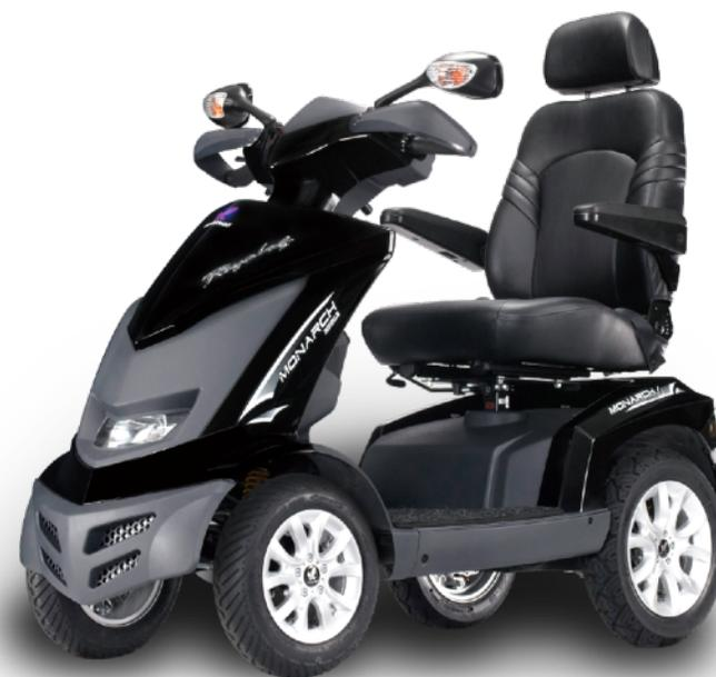
Le siège du **PF7** est testé selon EN1021 concernant la résistance au feu, mais il est recommandé d'éviter d'allumer une flamme près du scooter et de fumer assis sur le scooter.
